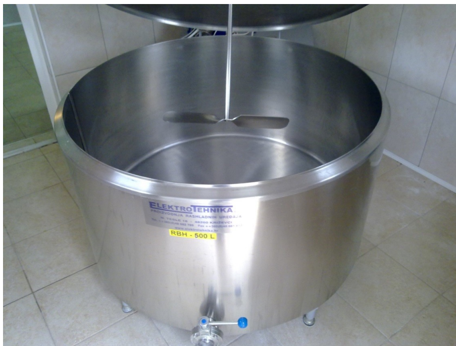
Slika 5. Laktofriz za hlađenje i čuvanje mlijeka (izvor: I. Novosel, tvrtka Elektrotehnika Križevci)
