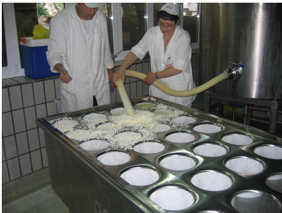
Slika 9. Istakanje smjese sirutke i suhog sirnog zrna u perforirane kalupe na sirarskom stolu (Izvor: S. Kalit)
